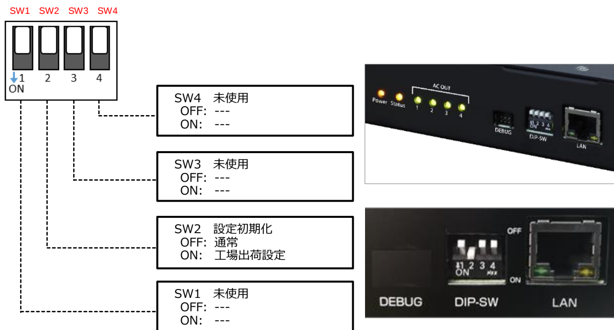
Fig.7 DIP スイッチ設定
