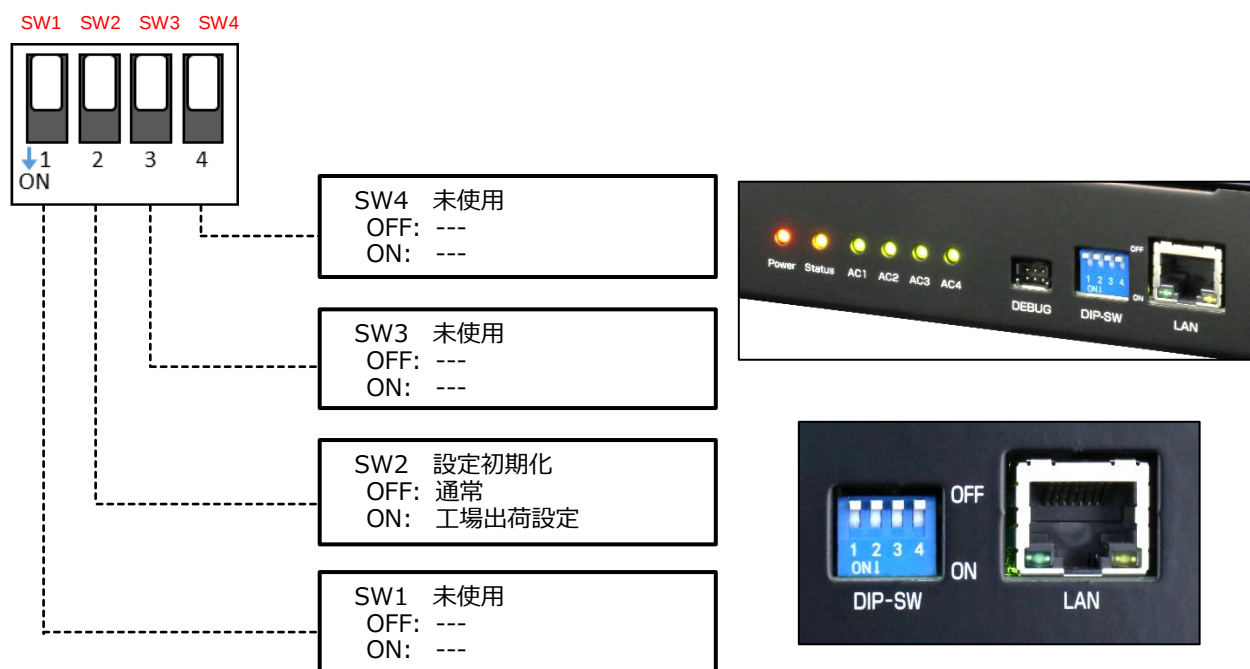
Fig. 7 DIP スイッチ設定
